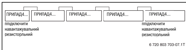
Мал. 10 Приклад для вмикання навантажувального резистора для декількох регулювальних пристроїв
