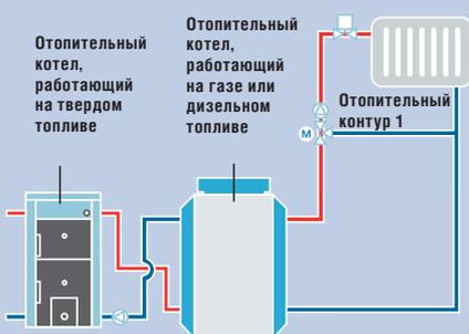
Котел Logano G221 может быть использован как автономный отопительный котел, работающий на твердом топливе, или в комбинации с отопительным котлом, работающим на газе или дизельном топливе.
