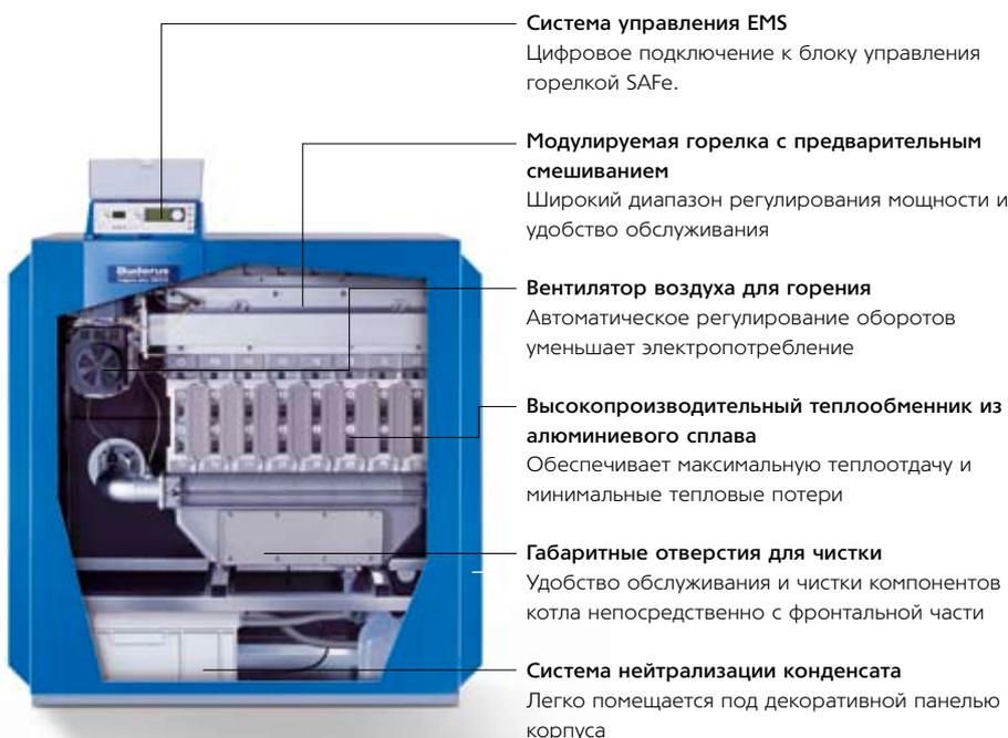
Благодаря компактным габаритам котла и возможности использования специальных комплектов для обвязки котла и систем дымоотведения, оборудование занимает удивительно мало места и идеально подходит для установки в помещениях с ограниченным пространством. Модулируемая горелка с предварительным смешиванием обеспечивает полное сгорание топлива, работу с уровнем шума, как от горелки атмосферного типа, и чрезвычайно низкие эмиссии.
