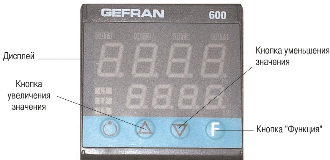
На дисплее отображается температура мазута. 4 светящихся индикатора относятся к следующим функциям:
