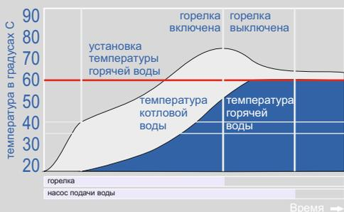
Совместное регулирование работы горелок и насоса подачи водонагревателя позволяет использовать остаточное и избыточное тепло котла для подогрева воды.
