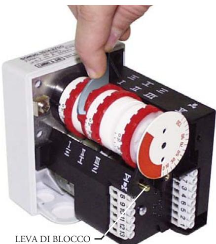
Togliere il coperchio per accedere alle camme di regolazione. Lo spostamento delle camme va effettuato con l'ausilio dell'apposita chiavetta in dotazione.
