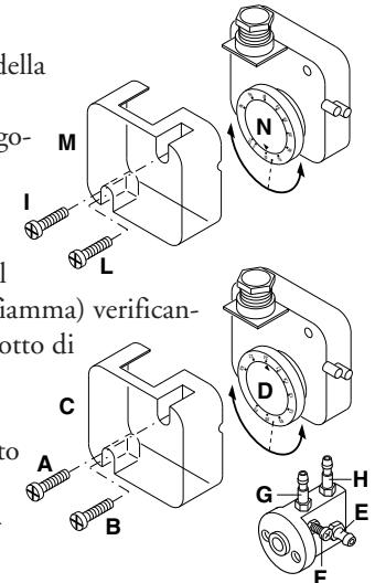
**REGOLAZIONE DEL PRESSOSTATO ARIA**
