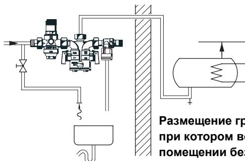
**Размещение группы безопасности "corner angle", при котором водонагреватель установлен в помещении без водоотводного устройства****Указания по установке**
