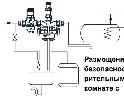
**Размещение группы безопасности с расширительным баком в одной комнате с водонагревателем**
