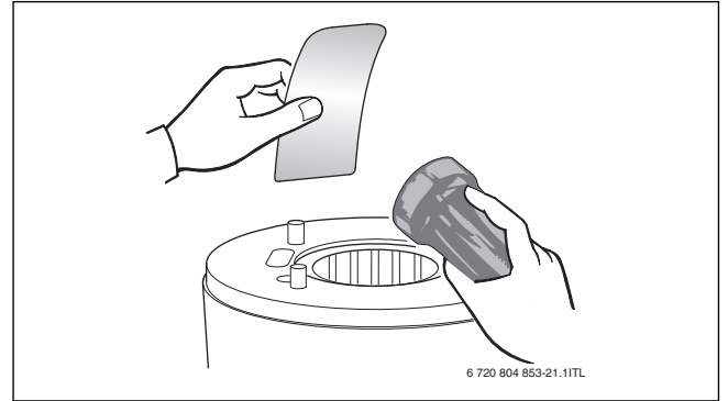
Мал. 46 Перевірка котлового блоку, який включає камеру згорання і теплообмінник, на наявність відкладень
