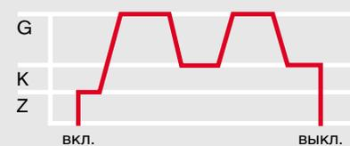
Двухступенчатый режим с сервоприводом
