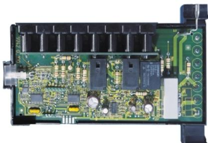
Все горелки Weishaupt типоряда W оснащаются цифровыми менеджерами горения. За контроль и управление всеми функциями горелки при этом отвечают мощные микропроцессоры. Вывод: горелки Weishaupt типоряда W удобны, точны и надежны.
