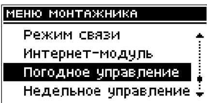
При помощи этого параметра является возможным настройка заданной температуры клапана для соответствующих величин наружной температуры. На основании установленных точек рассчитываются величины для промежуточных точек.
