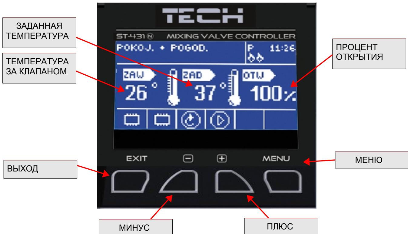
Принцип воздействия пульта управления на сервомотор клапана основан на смешивании питающей циркуляционной горячей воды с водой, которая возвращается из цикла подогрева, чтобы установить требуемую температуру и постоянно удерживать ее на одинаковом уровне.
