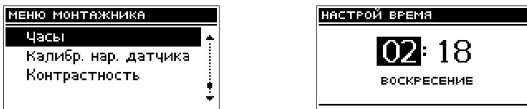
При помощи настройки таймера пользователь определяет текущее время и день недели. Без настройки времени правильное действие недельного регулирования не будет возможным.
