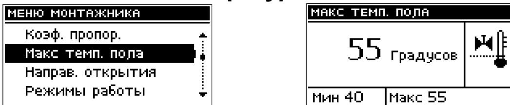
Это максимальная температура, которая не повредит инсталляцию обогрева пола. Настройка этой температуры используется, если тип клапана установлен на подогрев пола. После достижения этой температуры происходит полное закрытие клапана, а пользователю подается соответствующий сигнал тревоги. Если максимальная температура обогрева пола будет достигнута, то отключится функция *защита котла*. В таком случае наибольший приоритет будет иметь защита инсталляции обогрева пола.
