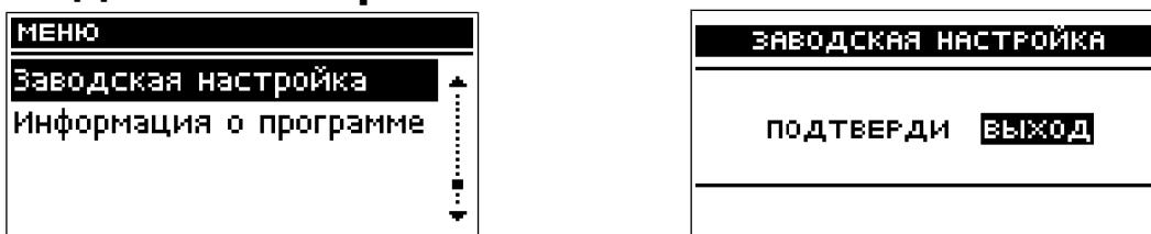
Регулятор имеет предварительную конфигурацию для работы. Тем не менее, его следует настроить для собственных потребностей. Всегда имеется возможность возвратиться к заводским настройкам. При включении опции Заводские настройки отменяются все собственные настройки пользователя и вступают в силу настройки производителя. С этого момента можно снова задавать свои необходимые параметры.
