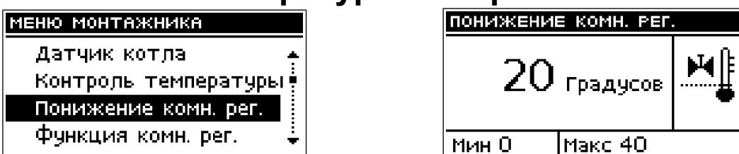
Эта функция активизируется только в случае, когда клапан взаимодействует с комнатным регулятором. В этой настройке следует задать значение температуры, при котором клапан снижает свою заданную температуру в момент достижения заданной температуры на комнатном регуляторе (нагревание помещения).
