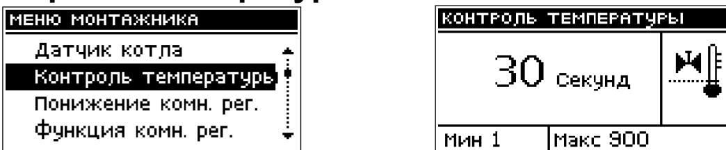
Этот параметр показывает частоту измерения (контроля) температуры воды за клапаном и до оборудования ЦО или подогрева воды. Если датчик указывает на изменение температуры (отклонение от заданной), то электроклапан приоткроется или закроется на установленный шаг чтобы возвратиться к заданной температуре.
