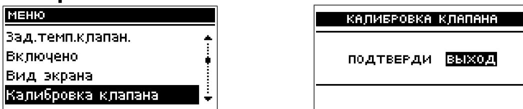
При помощи этой функции регулируются начальные установки клапана. Во время калибровки клапан устанавливается в безопасную позицию, то есть для клапана ЦО в позицию полного открытия, а для клапана обогрева пола в позицию закрыто. Во время проведения калибровки внизу экрана высвечивается символ:  $\blacktriangleright\bar{T}\blacktriangleleft$ .
