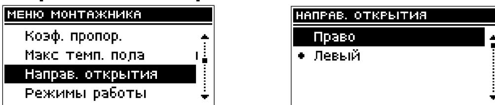
Если после подключения клапана к пульте управления окажется, что он должен быть подключен наоборот, то не нужно переключать провода подачи питания, а достаточно всего лишь изменить в этом параметре направление открытия.
