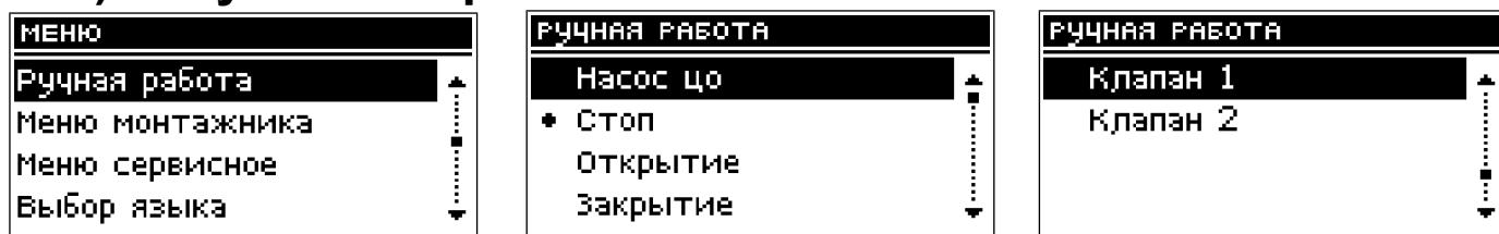
После выбора опции мануальный режим пользователь имеет возможность открывать/закрывать клапан вручную (а также дополнительные клапаны, если они активны), и включать или выключать насос для проверки правильности работы оборудования.
