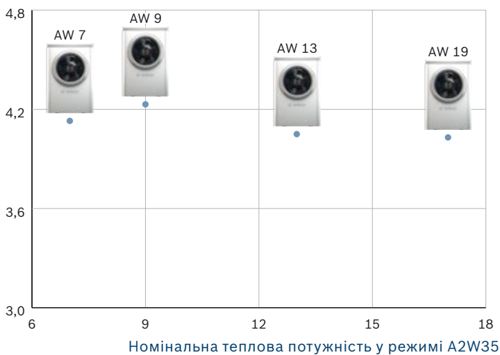
Коефіцієнт ефективності COP у режимі A2W35
