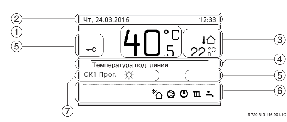
Мал. 11 Приклад дисплея стандартних показників в установці з кількома опалювальними контурами
