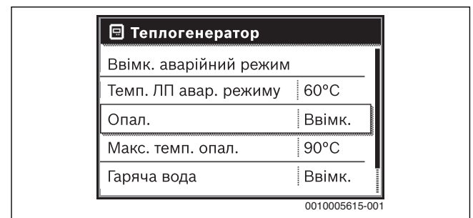
Мал. 23 Ввімкнення системи опалення
